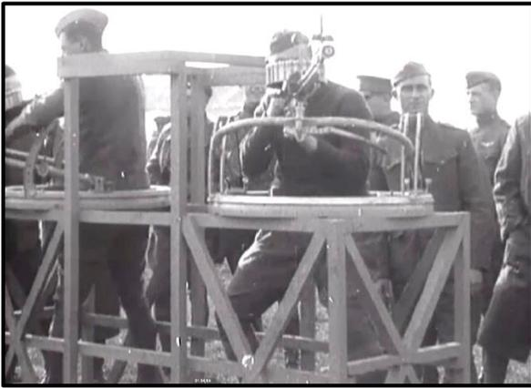
Figure 310 Tourelle au sol permettant d'apprendre le maniement de la mitrailleuse. (Photo Archives US)
